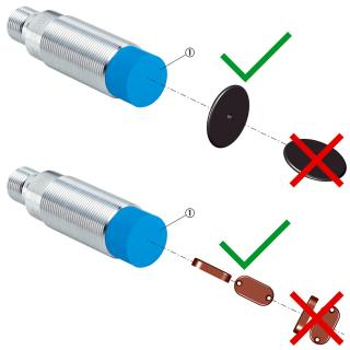
Alignement optimal des transpondeurs pour une opération d'écriture et de lecture sûre 1 Cache avec antenne intégrée
