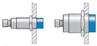
Dépassement requis du clapet actif au montage de l'appareil dans le métal (montage non noyable)
